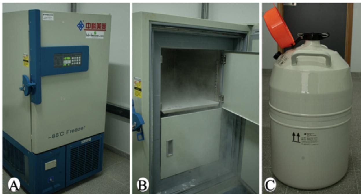
Fig. 57: A y B: se observa por fuera y por dentro un freezer de  $-80^{\circ}$ . C: se observa un termo utilizado tanto para almacenar nitrógeno líquido como para almacenar muestras cuando fijamos por método físico (foto Dra. Patricia Genovese)
